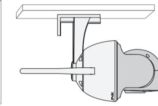
请用户按照说明书方式垂直安装设备，禁止错误方向安装，否则存在因进水导致设备报废风险！
